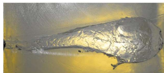
Simulierte Wundhöhle in ballistischer Seife - .300 Win. Mag. SPEED TIP PRO auf 350 m
